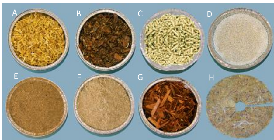
Figura 2. Panoramica dei diversi prodotti testati durante le attività di progetto. La ripresa è stata effettuata durante i test preliminari di laboratorio: A) Biopac® base lolla di riso, B) Biopac® base corteccino, C) Stropellet, D) PotClean®, E) Biopac® base segatura di faggio, F) Biopac® base segatura mista, G) TerrAktiv containermulch, H) Discoplus.
